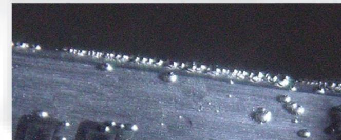
Кавитация на кромке металлической пластины в растворе CO2 в этаноле при прохождении ударной волны амплитудой 8 МПа
