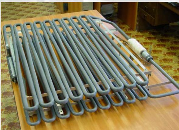
Созданы контурные тепловые трубы, способные эффективно передавать тепло в диапазоне температур от  $-50\text{ }^{\circ}\text{C}$  до  $+150\text{ }^{\circ}\text{C}$  при любой ориентации на расстояние до нескольких метров. А также реверсивные, разветвленные, гибкие, миниатюрные, регулируемые и другие устройства с мощностью от 1 до 3000 Вт и термическим сопротивлением от 0,1 до 0,2 К/Вт.
