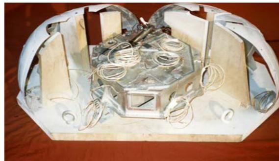
Компоновка системы терморегулирования с контурной тепловой трубой спускаемого аппарата космической программы «Марс-96»
