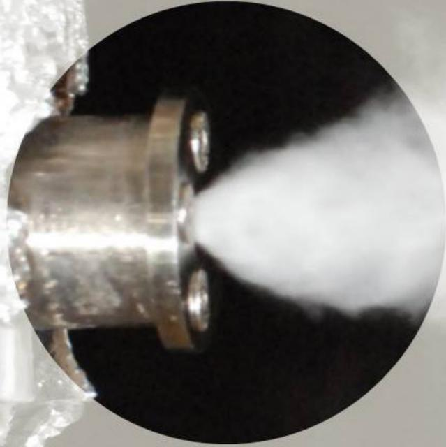
Впервые обнаружены кризисные явления в поведении реактивной отдачи струи воды в условиях взрывного вскипания и полный развал струи сильно перегретой воды.
