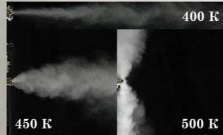
Формы струи вскипающей воды, истекающей через цилиндрический канал, при различных температурах
