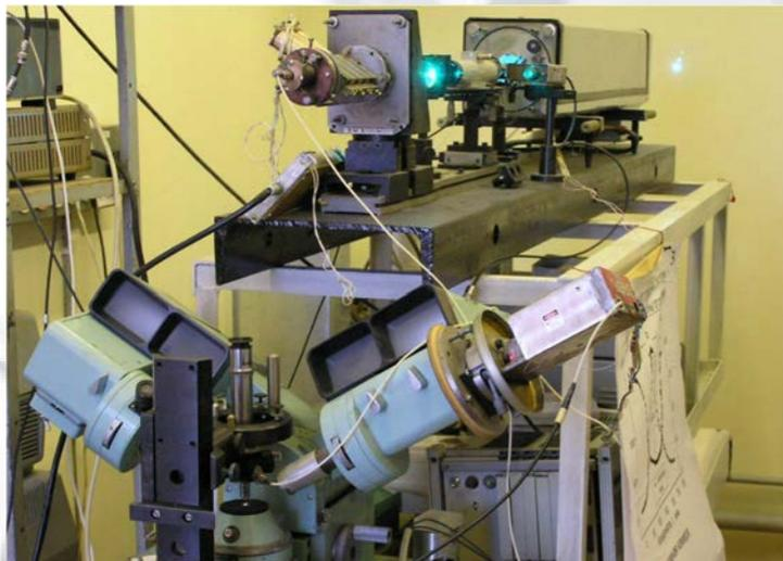
Разработан лазерный бесконтактный метод контроля качества покрытий и теплофизических свойств малых образцов и неоднородных материалов - "Оптическая тепловая микроскопия".
