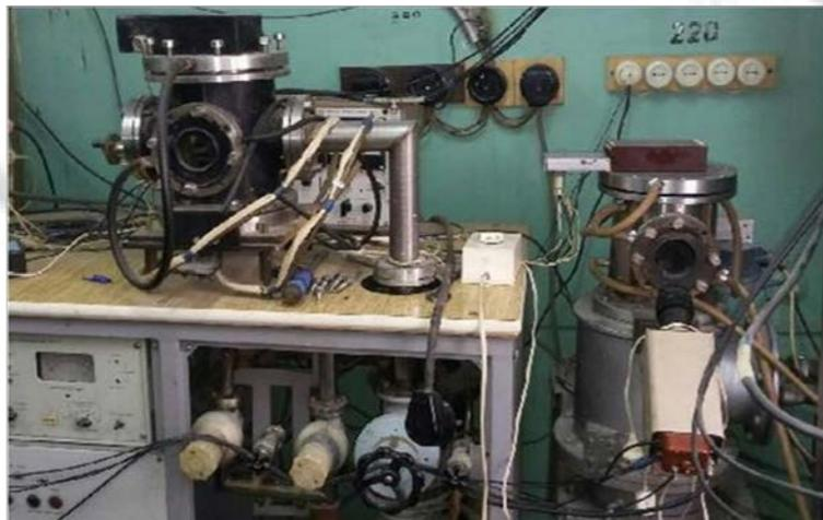
Измерительный комплекс позволяет определять температуропроводность металлов и сплавов вблизи структурных и магнитных фазовых превращений, включая область существования жидкой фазы, на образцах в форме тонких плоскопараллельных пластин диаметром 10 мм и толщиной не более 1 мм с погрешностью, не превышающей 3,5 % и разрешающей способностью около 0,5 %.
