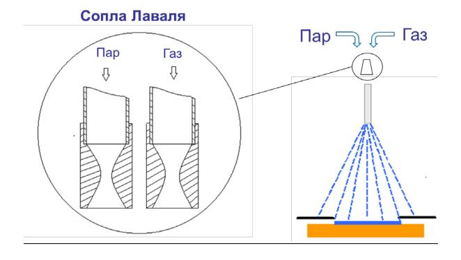
Рис.2. Схема получения газового гидрата
