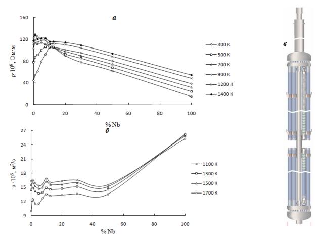
Рис. 4. a - удельное электросопротивление;  $\delta$  - температуропроводность;  $\epsilon$  - ТВЭЛ и тепловыделяющая сборка (ТВС) для энергетических реакторов РМБК-1000 и РМБК-15
