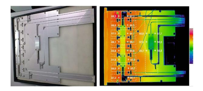
Рис.3. Внешний вид и температурное поле охлаждающей панели с контурными тепловыми трубами
